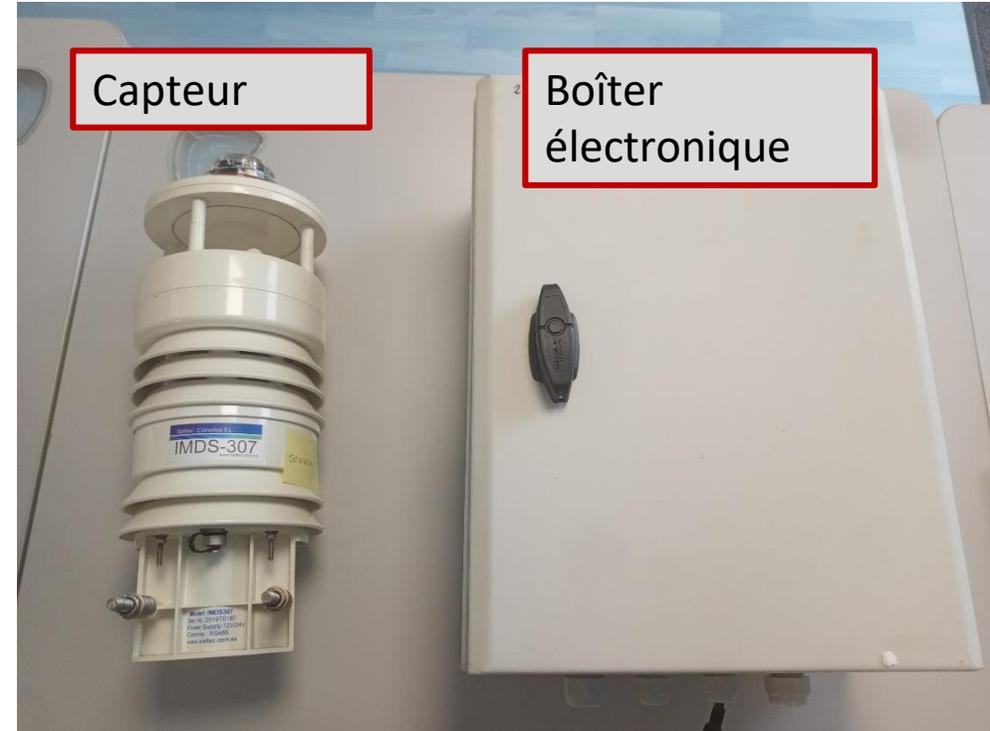
À l'intérieur du boîtier électronique, vous trouverez un capteur PMx à remplacer, si nécessaire
